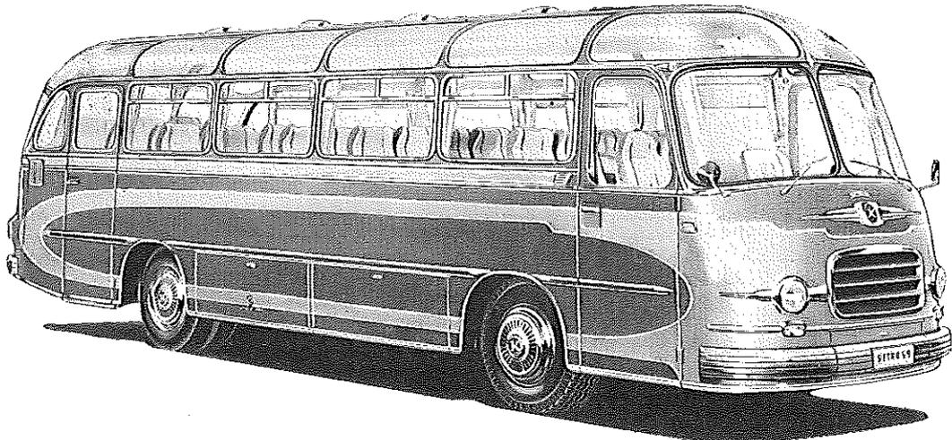
**Diesel-Motor · 6 Zylinder · 4-Takt · 125 PS bei 2500 U/min\***
